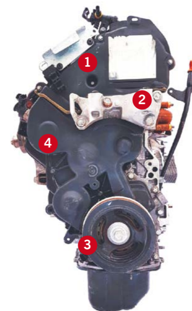
RYS. 2. MIEJSCE OSADZENIA BLOKADY UKŁADU KORBOWO-TŁOKOWEGO SILNIKA 1.6 HDI DV6 ETED: A – WIDOK OD STRONY ZEWNĘTRZNEJ SILNIKA, B – WIDOK OD STRONY KOŁA ZAMACHOWEGO, 1 – OTWÓR TECHNOLOGICZNY DO OSADZENIA BLOKADY
