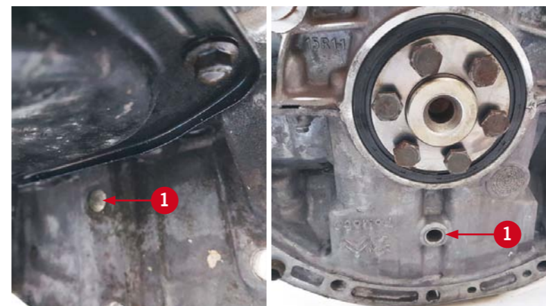
RYS. 2. MIEJSCE OSADZENIA BLOKADY UKŁADU KORBOWO-TŁOKOWEGO SILNIKA 1.6 HDI DV6 ETED: A – WIDOK OD STRONY ZEWNĘTRZNEJ SILNIKA, B – WIDOK OD STRONY KOŁA ZAMACHOWEGO, 1 – OTWÓR TECHNOLOGICZNY DO OSADZENIA BLOKADY
