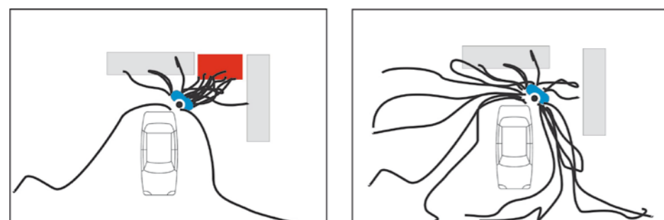
RYS. 1. POMIAR DROGI, JAKĄ PRZEBYWA PRACOWNIK PODCZAS NAPRAWY. PO LEWEJ – W PRZYPADKU SYSTEMU NARZĘDZI DO NAPRAW PANELOWYCH. PO PRAWIEJ – Z ZASTOSOWANIEM NARZĘDZI ROZPROSZONYCH W WARSZTACIE
