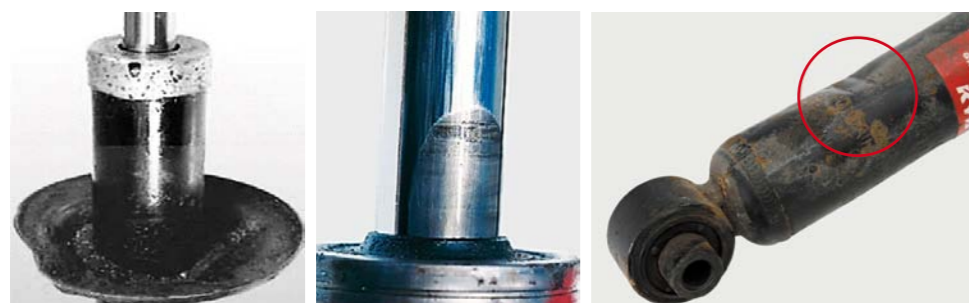
PRZYKŁADY TYPOWYCH USZKODZEŃ AMORTYZATORÓW
