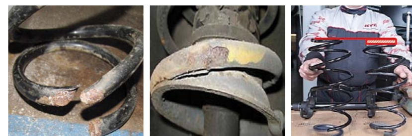
USZKODZENIA SPRĘŻYN ZAWIESZENIA
