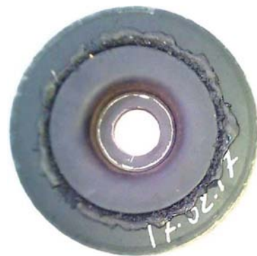
USZKODZONE KOŁO PASOWE
