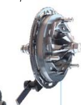
mechanizm ruchomych łopatek (turbosprężarka ze zmienną geometrią)
