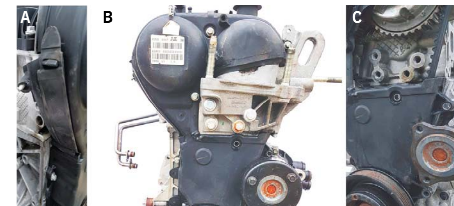
RYS. 6. OSŁONA PRZEKŁADNI PASOWEJ NAPĘDU UKŁADU ROZRZĘDU SILNIKA 1.5 ECOBOOST M8MA: A – WIDOK BOCZNY, STRONA PRAWA, B – WIDOK OD PRZODU SILNIKA, C – WIDOK PO DEMONTAŻU WSPORNIKA ŁĄPY MOCOWANIA SILNIKA I WIEŃCA KOŁA PASOWEGO NAPĘDU POMPY UKŁADU CHŁODZENIA
