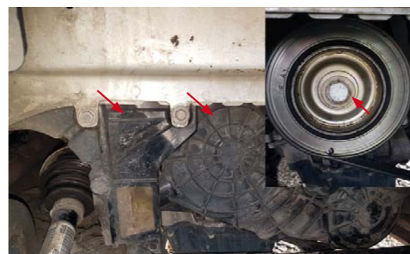
RYS. 2. PEUGEOT TRAVELLER Z SILNIKIEM 2.0 BHD1 – WSPORNIK NADKOLA, OSŁONA NAPĘDU OSPRZĘTU ORAZ KOŁO PASOWE NAPĘDU OSPRZĘTU (OZNACZENIE STRZAŁKAMI)
