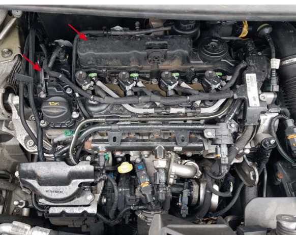
RYS. 1. KOMORA SILNIKA PEUGEOT TRAVELLER Z SILNIKIEM 2.0 BHD1. OZNACZANIE POKRYWY GŁOWICY I OSŁONY NAPĘDU PASOWEGO UKŁADU ROZRZĄDU
