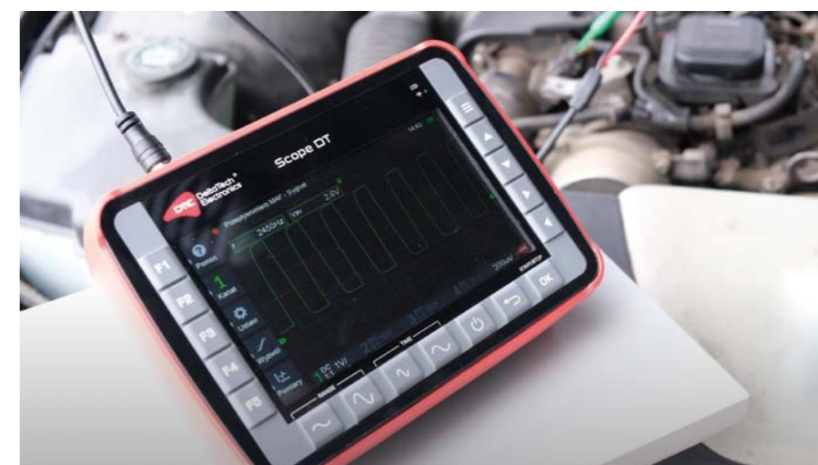
FOT. 2. OSCYLOSKOP POMOŻE SPRAWDZIĆ SYGNAŁY STERUJĄCE ORAZ POCODZĄCE Z CZUJNIKÓW
