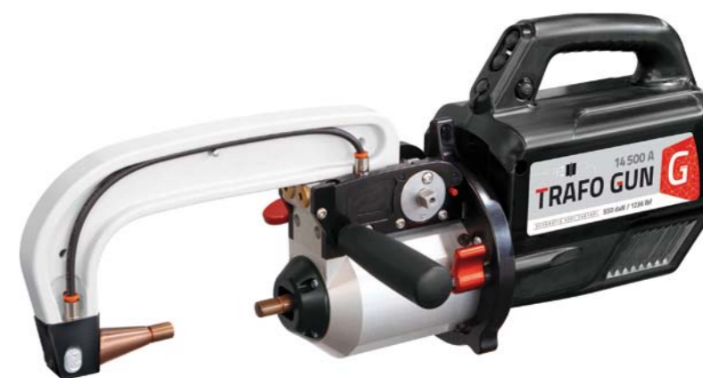
RYS. 3. UCHWYT TYPU „C” Z TRANSFORMATOREM UMOŻLIWIA ZASTOSOWANIE PRZEWODÓW O ZNACZNIE MNIEJSZYM PRZEKROJU ORAZ MOŻE BYĆ STOSOWANY PRZY MNIEJSZYM ZABEZPIECZENIU LINII O NIŻSZYCH PARAMETRACH
