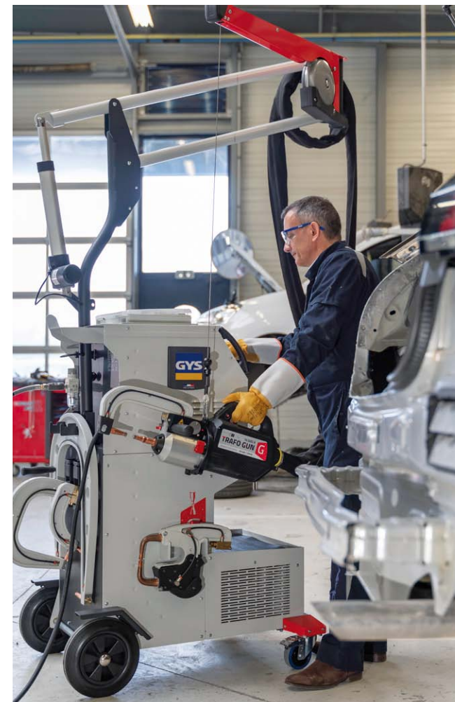
RYS. 7 I 8. NOWOCZESNA, WIELOFUNKCYJNA ZGRZEWARKA INWERTOROWA GYSPOT PTI.G
