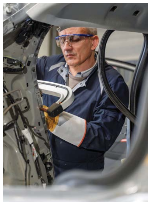
RYS. 5. UŻYCIĘ ZGRZEWARKI Z UCHWYTEM TYPU „C”
