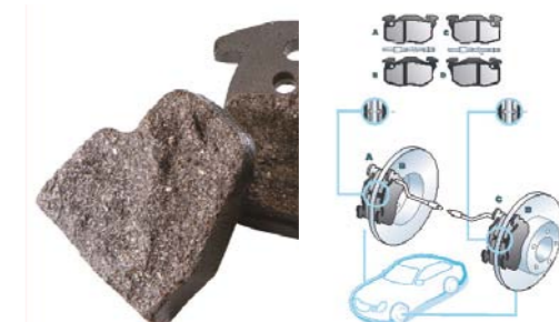
NIEPRAWIDŁOWY MONTAŻ KLOCKÓW (ZACISK TYPU BENDIX IV)
