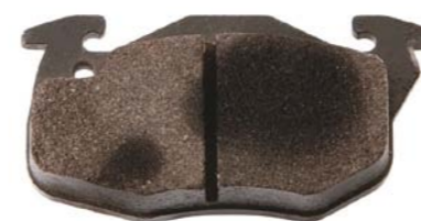
ZANIECZYSZCZENIE MATERIAŁU CIERNEGO
