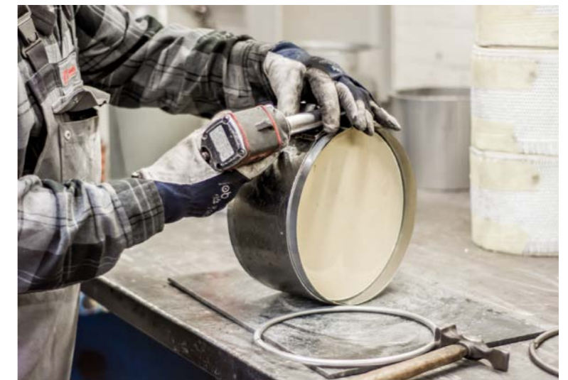
REGENERACJA KATALIZATORA SCR PRZEZ WYMIANĘ WKŁADÓW
