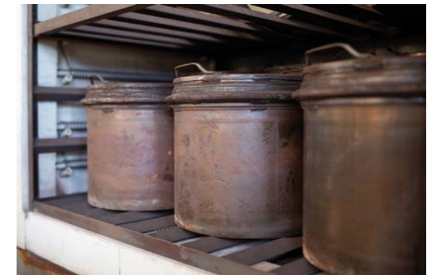
REGENERACJA FILTRÓW POPRZEC WYPALANIE W PIECU
