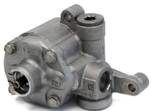
FOT. 1. ŁOPATKOWA POMPA OLEJU SKRZYNI NISSAN QASHQAI NAPĘDZANA PRZEZ KONWERTER ŁAŃCUCHEM
