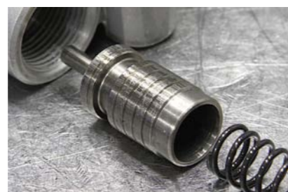
FOT. 2. ZUŻYTY ZAWÓR KONTROLI PRZEPŁYWU OLEJU
