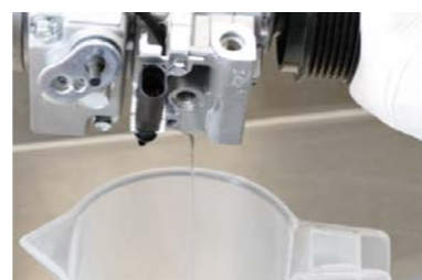
SPUSZCZANIE OLEJU Z NOWEGO KOMPRESORA W CELU OKREŚLENIA JEGO ILOŚCI
