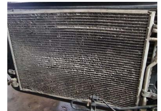
RYS. 4. SKRAPLACZ KLIMATYZACJI Z NAGROMADZONYMI ZANIECZYSZCZENIAMI
