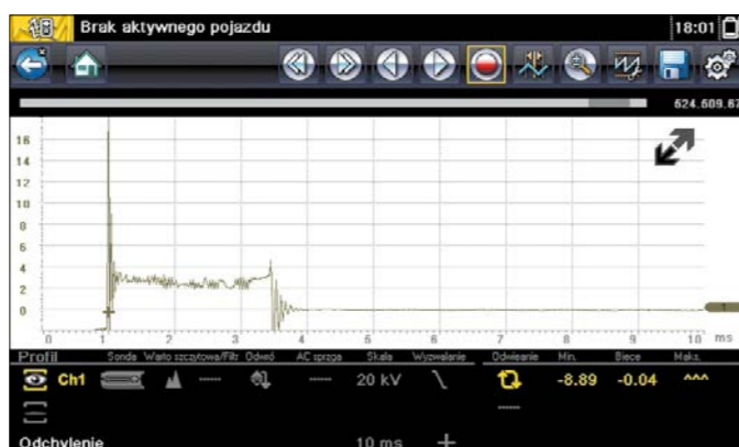
FOT. 2. PRZEBIEG NAPIĘCIA NA PRAWIDŁOWO DZIAŁAJĄCEJ CEWKIE
