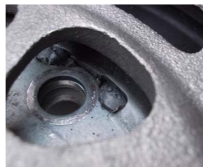
STOPIENIE PLYTKI FCP PO PRZEBIEGU KILKU TYSIĘCY KILOMETRÓW
