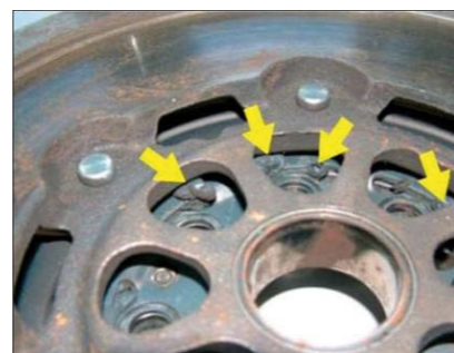
USZKODZONA PLYTKA NA SKUTEK NIEDOMAGAŃ SILNIKA PUMA
