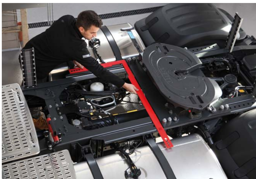
RYS. 5. POMIARY KSZTAŁTU RAMY PRZED DIAGNOSTYKĄ GEOMETRII KÓŁ I OSI
