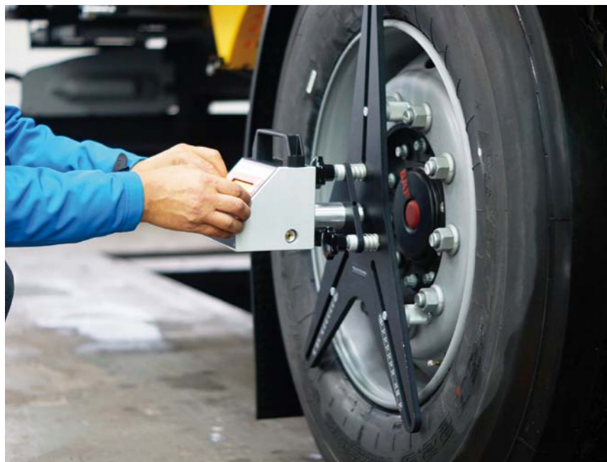
RYS. 4. MOCOWANIE MAGNETYCZNE UCHWYTU GŁOWICY POMIAROWEJ
