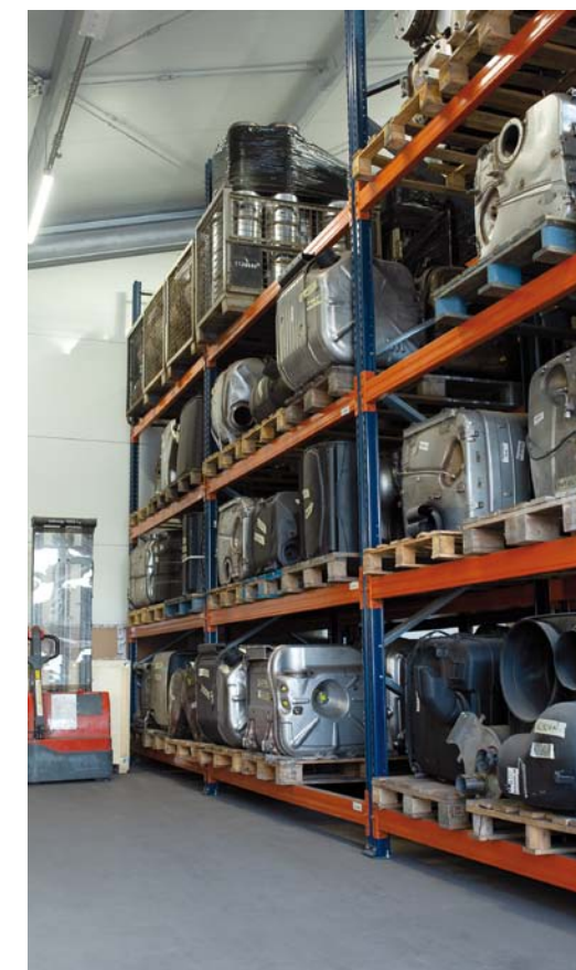
ZREGENEROWANE KATALIZATORY POJAZDÓW CIĘŻAROWYCH Z WYMIENIONYMI WKŁADAMI NA REGAŁACH MAGAZYNOWYCH FIRMY KALIŃSKI
