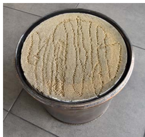
POKRUSZONY WKŁAD FILTRA DPF (Z LEWEJ) I WKŁAD ZNISZCZONY PRZEZ PRÓBĘ UMYCIA MYJKĄ CIŚNIENIOWĄ
