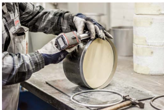
WYMIANA WKŁADU KATALIZATORA DO SAMOCHODU CIĘŻAROWEGO
