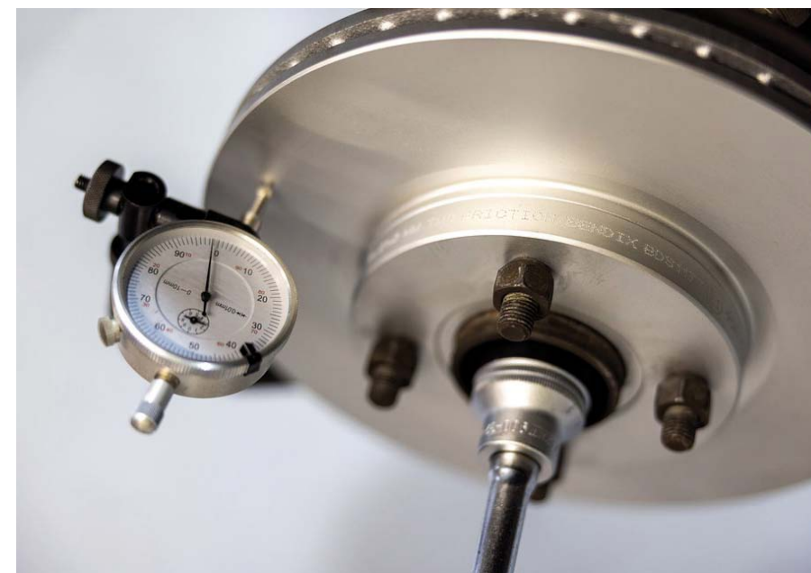
SPRAWDZANIE BICIA BOCZNEGO ZA POMOCĄ CZUJNIKA ZEGAROWEGO
